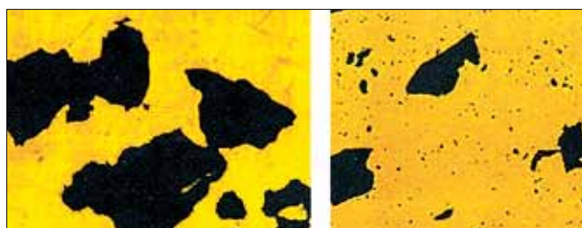
Рис. 9. Морфология вяжущего с масляным наполнителем и без него.
