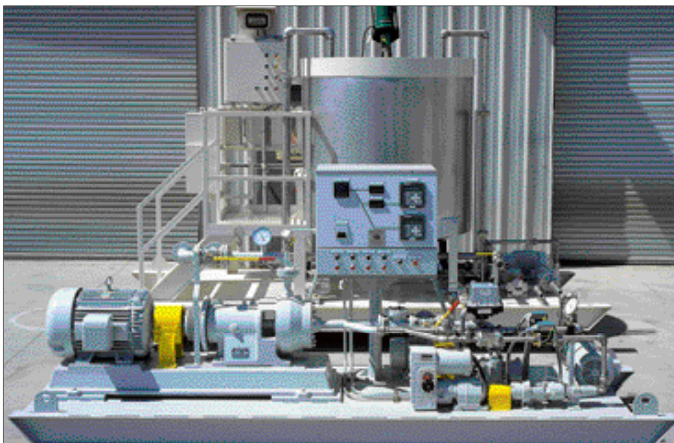
Эмульсионная установка на базе мельницы Charlotte, размер частиц менее 5 микрон.
