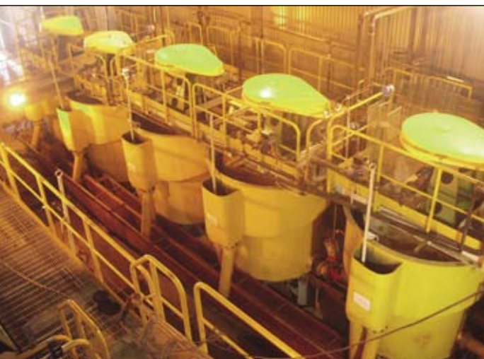
Рис. 9. Флотомашины ТС-40 Outotec (Outokumpu Technology). Суздальское месторождение, АО ФИК «АЛЕЛ», Казахстан
