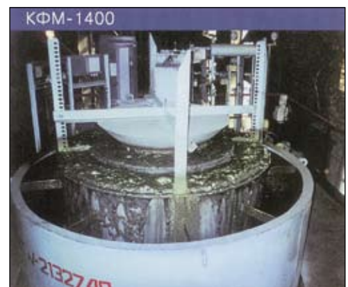
Рис. 15. Машина серии КФМ, «Уралмеханообр» (патенты РФ №2132749, №2151648, №219074)
